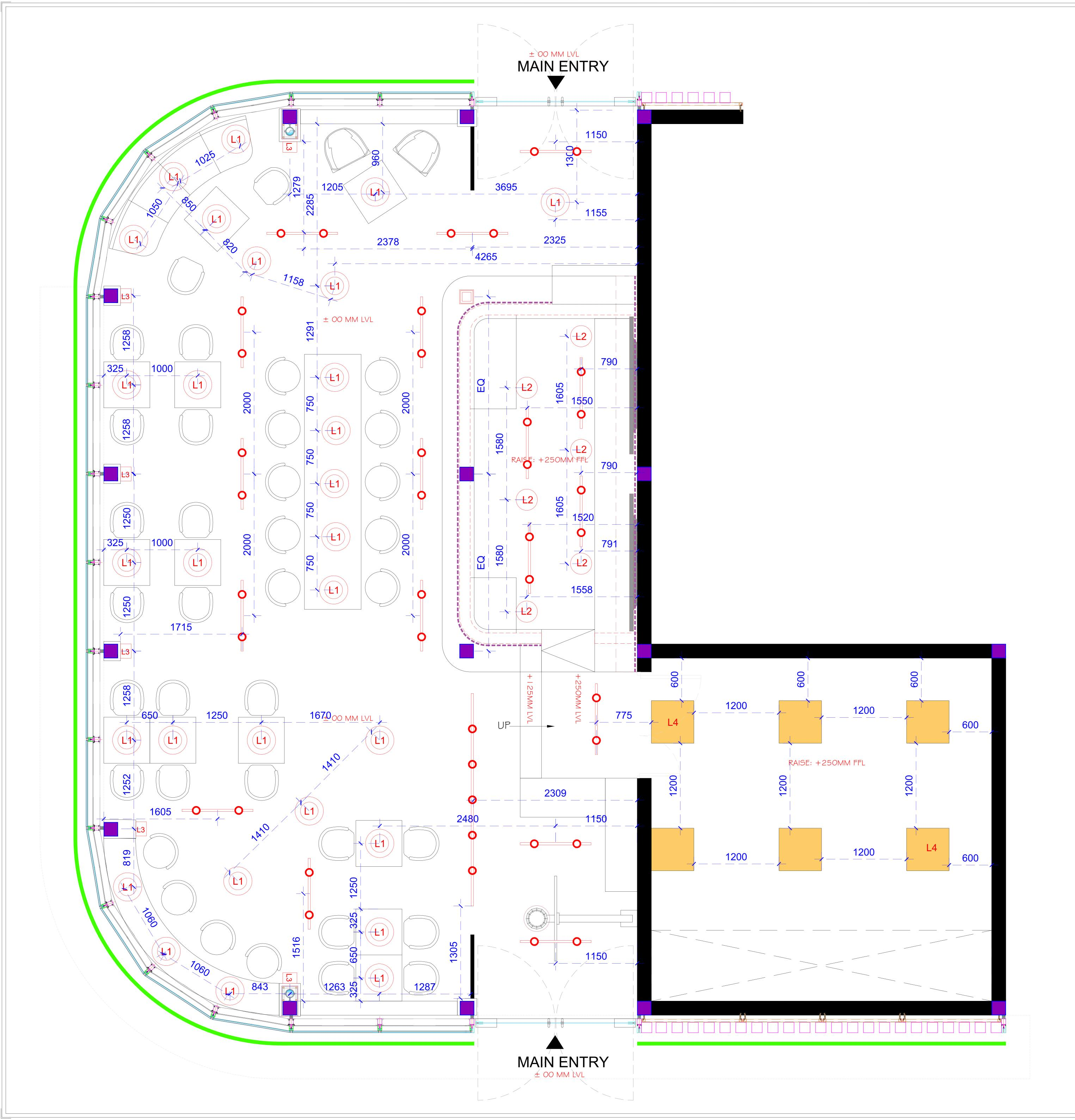
**LEGEND**: **TEMPERATURE** SYMBOL DESCRIPTION 3000K 450MM DIA. HANGING LIGHT 3000K 300MM DIA. HANGING LIGHT 3000K L3 WALL LIGHT 6000K 600MM PANEL LIGHT 3000K 1 000MM TRACK LIGHT 4000MM TRACK LIGHT 3000K LED STRIP LIGHT 3000K
